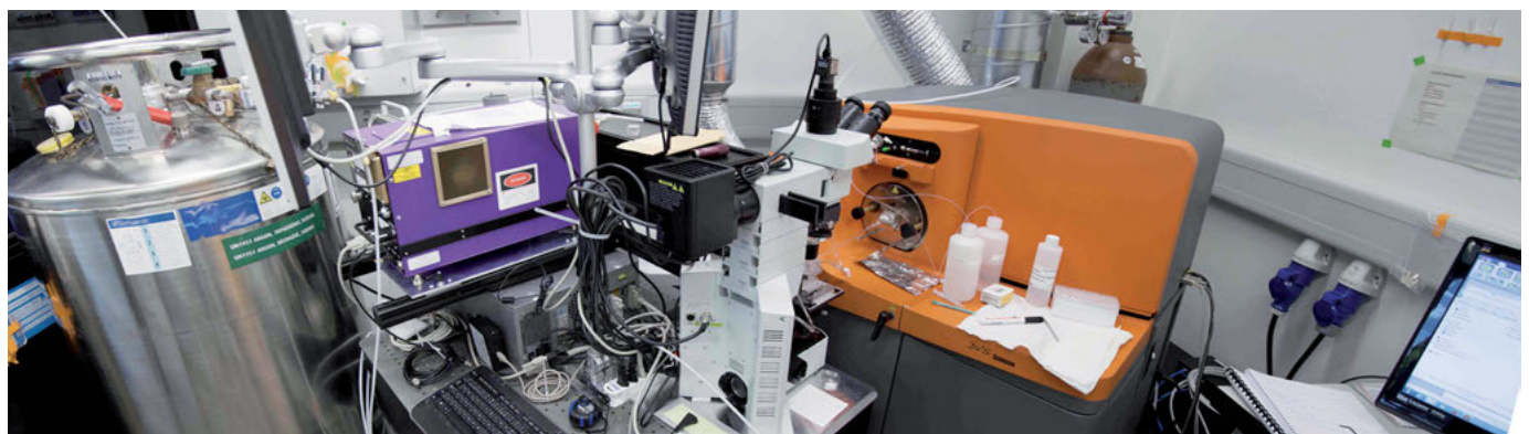
Bernd Bodenmillers Team verwendet die Imaging Mass Cytometry für die Detektion von Proteinen und RNA in Gewebeschnitten. Dazu werden die Gewebeprobe mit Metall-gelabelten Antikörpern markiert und mit dem Strahl eines UV-Lasers (violett) unter dem Mikroskop abgetragen (ablatiert). Über einen Gasstrom wird das ablatierte Gewebe schließlich in das CyTOF-Instrument (orange) überführt und analysiert.
